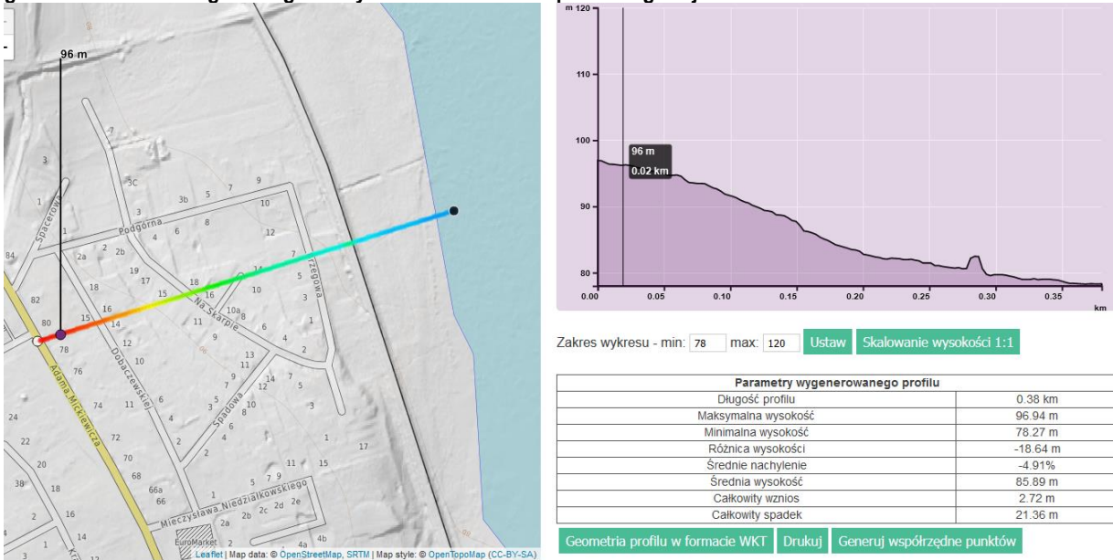
Rys. 4 – Przekrój podłużny terenu na podstawie numerycznego modelu terenu - pomiędzy ul. Mickiewicza a brzegiem Jeziora Żnińskiego Dużego na wysokości ulic Na Skarpie i Brzegowej.
